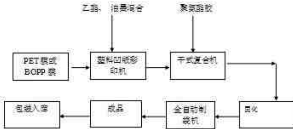
图2-2 生产工艺流程及产污环节图
